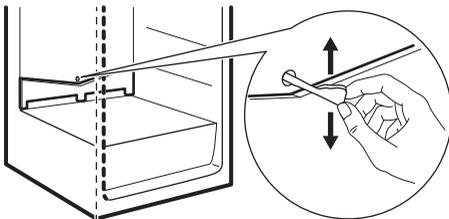
En fonctionnement normal, le givre est automatiquement éliminé de l'évaporateur du compartiment réfrigérateur à chaque fois que le compresseur s'arrête. L'eau de dégivrage est collectée dans un récipient spécial situé à l'arrière de l'appareil, au-dessus du compresseur, d'où elle s'évapore.
