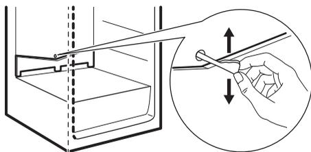
Durante l'uso normale, la brina viene eliminata automaticamente dall'evaporatore del vano frigorifero ogni volta che il motore compressore si arresta. L'acqua di sbrinamento giunge attraverso un condotto in un apposito recipiente posto sul retro dell'apparecchiatura, sopra il motore compressore, dove evapora.
