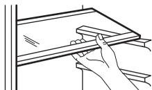
Les glissières se trouvant sur les parois de la cuve vous permettent de positionner les clayettes à différentes hauteurs, selon vos besoins.
