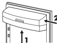
En fonction de la taille des emballages des aliments conservés, les balconnets de la porte peuvent être positionnés à différentes hauteurs.
