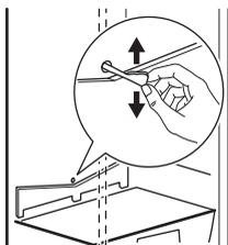
En fonctionnement normal, le givre est automatiquement éliminé de l'évaporateur du compartiment réfrigérateur à chaque fois que le compresseur s'arrête. L'eau de dégivrage est collectée dans un récipient spécial situé à l'arrière de l'appareil, au-dessus du compresseur, d'où elle s'évapore.
