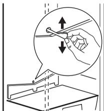
Durante l'uso normale, la brina viene eliminata automaticamente dall'evaporatore del vano frigorifero ogni volta che il motore compressore si arresta. L'acqua di sbrinamento giunge attraverso un condotto in un apposito recipiente posto sul retro dell'apparecchiatura, sopra il motore compressore, dove evapora.
