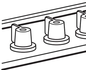
6. Controleer of de knoppen correct geïnstalleerd zijn door elke brander apart in te schakelen.
