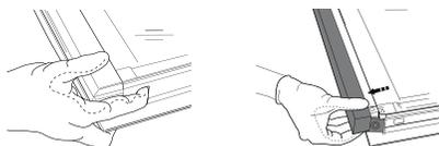
2. Sollevare e prendere saldamente il vetro interno con due mani, rimuoverlo e appoggiarlo su un piano morbido prima di eseguire la pulizia. Eseguire la stessa operazione per il vetro intermedio.
