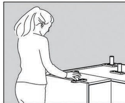
Monter les caissons bas suivant les instructions. Attention à poser les pieds dans l'ordre d'installation des caissons.
