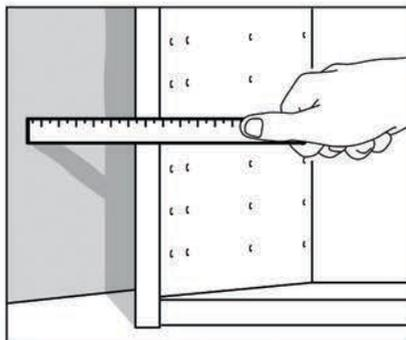
À l'aide du niveau à bulle, contrôlez la planéité du mur. Si le mur est bien rectiligne, mesurez la distance entre le mur et le caisson et reportez-la en haut et en bas du filler.
