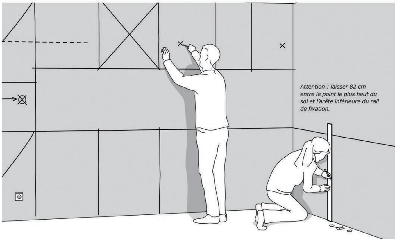
Attention : laisser 82 cm entre le point le plus haut du sol et l'arête inférieure du rail de fixation.
