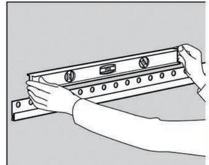
Contrôler l'horizontalité du rail au niveau à bulle.
