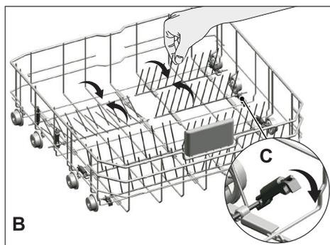
Pour mettre les picots rabattables en position horizontale, tenez-les par le milieu et poussez-les dans le sens des flèches (B). Pour remettre les picots en position verticale, contentez-vous de les redresser. Les picots rabattables s'enclencheront à nouveau dans le loquet (C).
