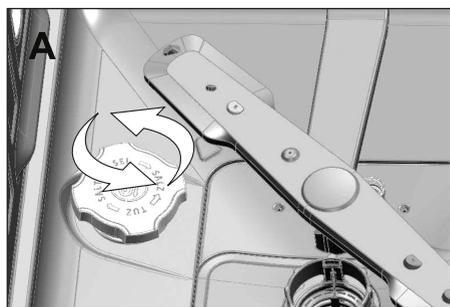
3. Ajoutez 1 litre d'eau dans le réservoir de sel de l'appareil uniquement lors de la première utilisation.
