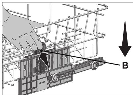
**i** Le mécanisme de déplacement peut ne pas fonctionner correctement si le panier supérieur est surchargé ou si la répartition du poids n'est pas équilibrée. Avec des charges très lourdes, le panier peut chuter à un niveau inférieur.
